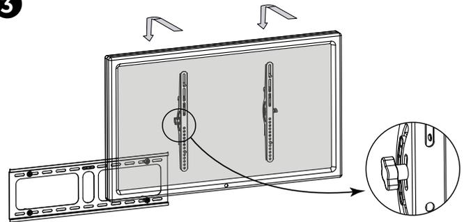
È possibile bloccare le braccia al termine dell'installazione.
