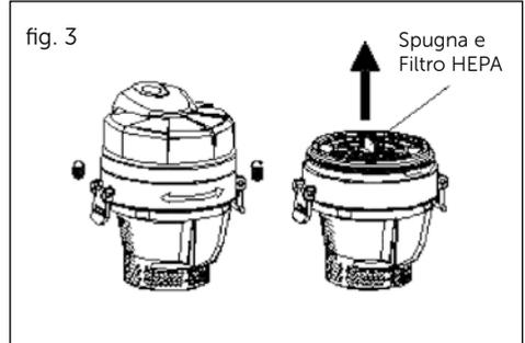
3. Alzare la maniglia del telaio del filtro ed estrarre la spugna e il filtro HEPA dalla custodia. Pulire la spugna e il filtro HEPA con una spazzola morbida o sciacquarli in acqua tiepida e **asciugarli completamente prima di utilizzarli di nuovo.**
