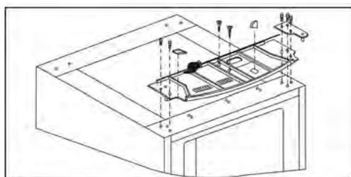
Svitare il perno superiore e avvitarlo in posizione analoga sul lato opposto. Montare la porta all'interno del perno superiore e chiuderla. Avvitare saldamente in posizione la staffa del perno inferiore del cardine sul fianco opposto impiegando le viti.
