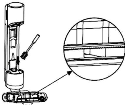
Smontare il serbatoio dell'acqua di scarico e pulire l'interno della porta di aspirazione con un panno umido o una spazzola per la pulizia.
