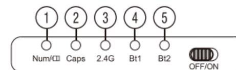
1. Batteria scarica/Blocco numeri (se la batteria è scarica, la spia lampeggerà)
