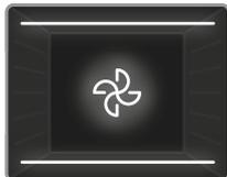
**Funzione cottura ventilata:** il termostato del forno e le spie si accendono, ed entrano in funzione gli elementi riscaldanti inferiore e superiore, e la ventola.
