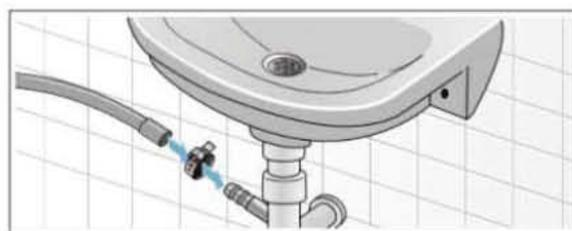
Fissare il tubo di scarico al sifone del lavandino utilizzando una fascetta stringitubo  $\varnothing 0.9-1.6$  in. (20-44 mm) (disponibile presso un negozio di ferramenta).
