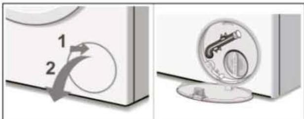
4. Usare il tubo di scarico estraibile situato nell'apertura di accesso alla pompa per scaricare l'acqua rimanente in un contenitore adatto (è possibile scaricare fino a 5,3U.S.gallon/20 litri d'acqua). Tirare il tappo di chiusura dal tubo e appoggiare il tubo sul lato del contenitore e lasciare che l'acqua finisca di defluire dal fusto. Al termine, rimettere il tappo di chiusura all'estremità del tubo e rimettere il tubo nella sua posizione di conservazione.
