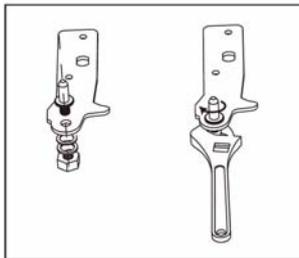
7. Riposizionare e riavvitare la cerniera inferiore, poi rimettere entrambi i piedini regolabili.
