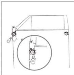
8. Rimontare la porta, assicurandosi che sia ben allineata in verticale ed orizzontale prima di riavvitare la cerniera superiore.
