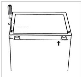
2. Rimuovere il top e la manopola del termostato, e metterli da parte.
