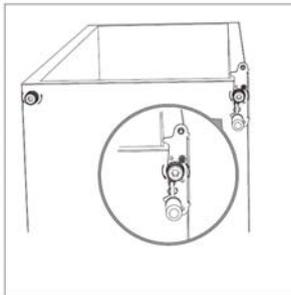
5. Svitare e rimuovere il perno avvitato nella cerniera inferiore.
