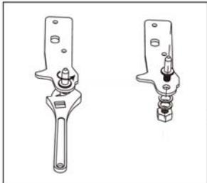
6. Ruotare la cerniera di 180° e riavvitare il perno.
