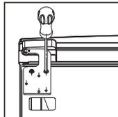
3-Rimuovere la copertura di plastica tirandola verso l'alto e i manicotti con un cacciavite a punta piatta. Vi preghiamo di prestare attenzione ai cavi contenuti all'interno del manicotto. Fatto ciò spostate il cavo con il connettore sull'altro lato e installate il manicotto sull'altro lato e montate lo sportellino posteriore.
