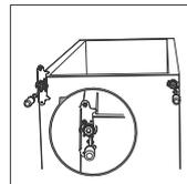
9-Rimuovere supporto in plastica e relativa staffa presenti sul lato inferiore della porta superiore, svitando la vite di fissaggio.
