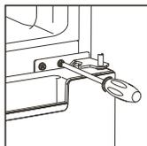
5-Dopo aver inclinato leggermente l'apparecchio, rimuovere la cerniera sulla parte inferiore dell'apparecchio ed entrambi i piedini.
