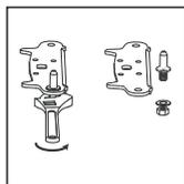
7-Applicare la cerniera sul lato opposto e riavvitarla con le sue viti. Riposizionare entrambi i piedini regolabili. Inserire la porta del vano frigorifero sulla staffa della cerniera inferiore avendo cura che le guarnizioni siano allineate
