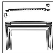
4-Rimuovere la cerniera intermedia fra le due porte, come mostrato in figura; rimuovere la porta del vano frigorifero sfilandola dall'alto. Riporre la porta su una superficie morbida onde evitare danni.
