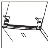
2-Rimuovere la cerniera sul lato superiore del frigorifero, svitando le viti che la fissano al prodotto; rimuovere la porta del vano congelatore sfilandola dall'alto. Riporre la porta su una superficie morbida onde evitare danni.
