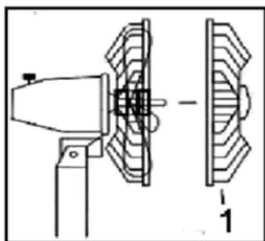
8. Riposizionare il coperchio anteriore (1) sul coperchio posteriore (5) e serrare i morsetti per assemblare completamente il copripale.
