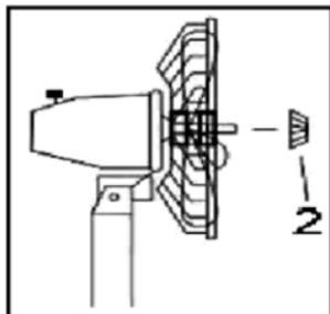
7. Avvitare il dado di fissaggio delle pale (2) sull'albero motore (6) ruotandolo in senso antiorario.
