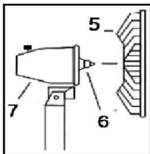
5. Posizionare il coperchio posteriore (5) sul motore (7) e avvitare il dado di fissaggio del coperchio posteriore (4).
