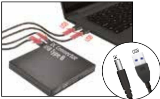
NOTA: se l'USB del computer non supporta energia sufficiente per far funzionare il masterizzatore CD/DVD, utilizzare il cavo di alimentazione di riserva per una migliore connessione di alimentazione.
