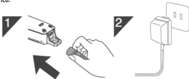
Questo apparecchio può essere utilizzato senza cavo quando è completamente carico. Se la carica della batteria è bassa, il cavo di alimentazione può essere collegato direttamente all'apparecchio per un uso continuato come apparecchio con cavo.
