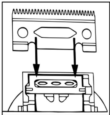
Per riallineare le lame, è sufficiente far combaciare i denti delle lame superiore e inferiore, punto per punto. L'estremità dei denti della lama superiore dovrebbe trovarsi a circa 0,5-1,0 mm dalla lama inferiore. Confronta le lame del regolabarba con il disegno a sinistra.
