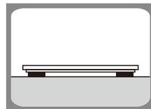
Passaggio 1: per garantire la precisione, posizionare la bilancia su un pavimento duro e piano ed evitare tappeti o superfici morbide.
