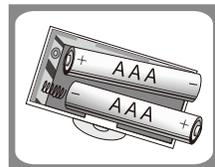
Aprire il coperchio della custodia della batteria sul retro della bilancia, se la custodia della batteria è del tipo mostrato in figura .
