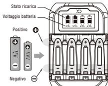
Si prega di inserire le batterie come sopra, altrimenti il caricabatterie non può funzionare. Assicurarsi che le batterie siano in buone condizioni e inserite correttamente.
